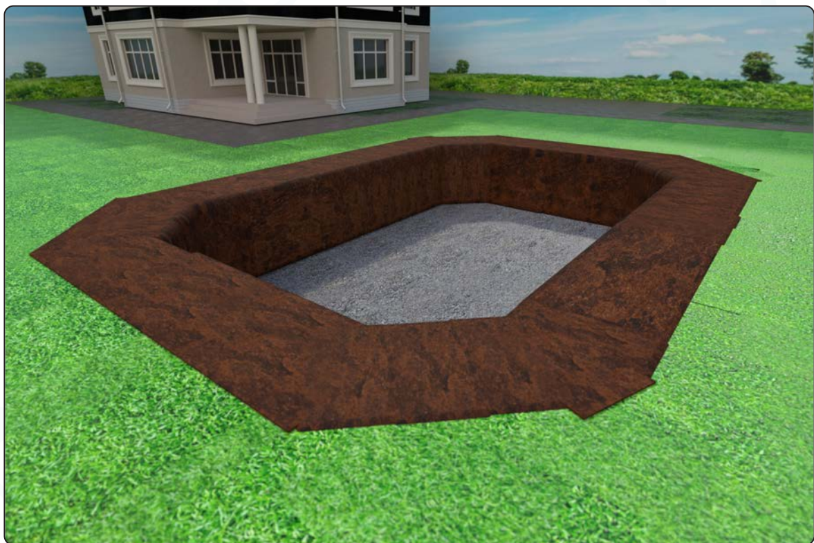
Baugrube mit zusätzlicher Schotterschicht
