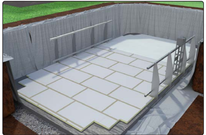
Bodenvlies Quer zur Stahlwand legen
