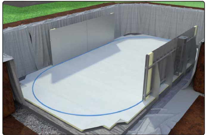
Bodenschiene fertig gesteckt
